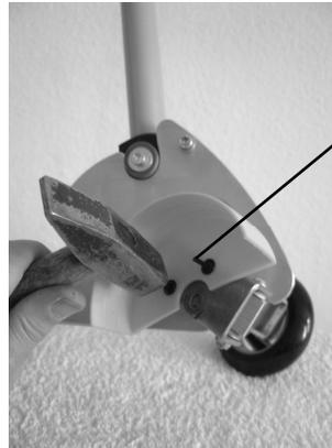
Plastikniete von innen durch die Bohrungen in den Schutzblechen stecken
